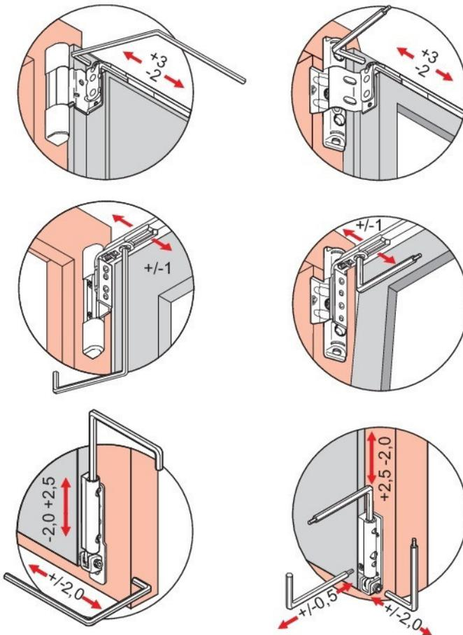
\* Při použití krytek (držák / rámové ložisko) a bezpečnostního zajištění ložiska se mění uváděné hodnoty seřízení.
